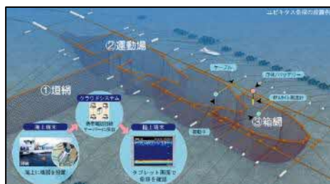
定置網へのユビキタス魚探の設置例 出典：「産学官の道しるべ」ICT 活用による定置網漁業の効率化ユビキタス魚探の開発
